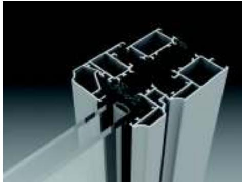
Hermes is een 3-kamer raam- en deursysteem in hoogwaardig aluminium dat een verhoogde kwaliteit biedt qua stabiliteit gecombineerd met een extreem hoge isolatiewaarde. Zowel kader- als vleugelprofielen zijn voorzien van een supplementaire derde kamer met extra hoekverbinding die een verhoogde stevigheid bieden.
